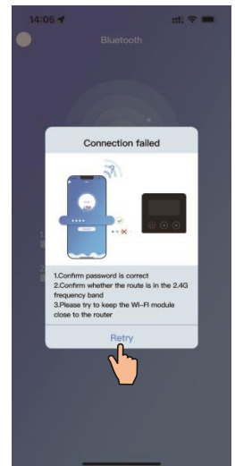
Abb.15 Es kann keine Verbindung zur WLAN-Schnittstelle hergestellt werden
